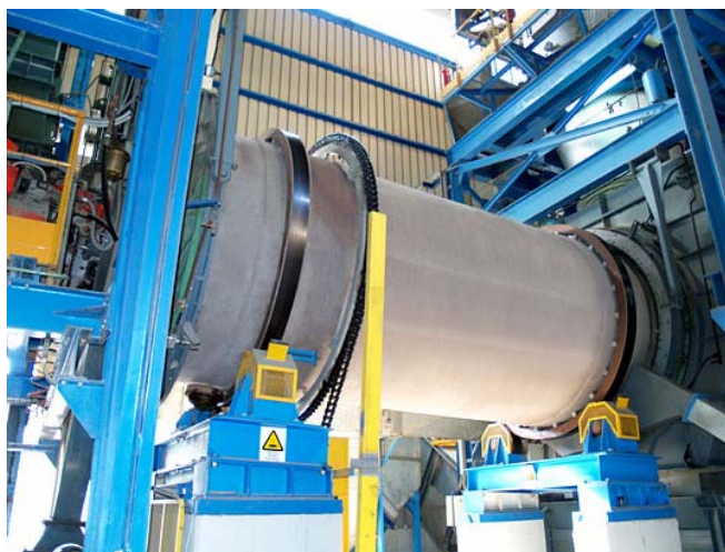
Εικόνα 6.2-1: Περιστροφικός κλίβανος
